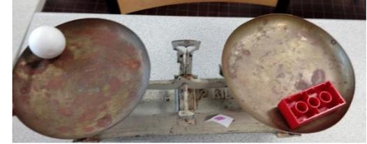
On équilibre la balance pour chaque boule avec des petits cube (ou duplo) identiques. Utilisation d'un étalon pour mieux construire le concept de la grandeur masse, avant d'utiliser sa mesure direct (masses marquées en g).
